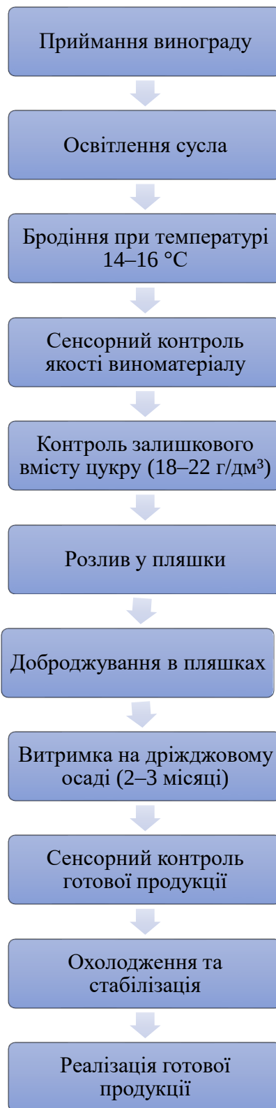
Мал.3.1.Удосконалена технологічна схема виробництва вин типу Pet Nat
