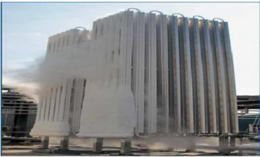
Рис. 3.12. Теплообмінник - регазифікатор СПГ з використанням теплоти морської води Середня вартість одного терміналу СПГ сягає 800 млн. доларів. Основні складові вартості терміналу при будівництві терміналу СПГ наступні: причал — 11 %; СПГ сховище — 45 %; технологічне обладнання — 24%; допоміжне обладнання — 16 %; допоміжні будівлі — 4 %.
