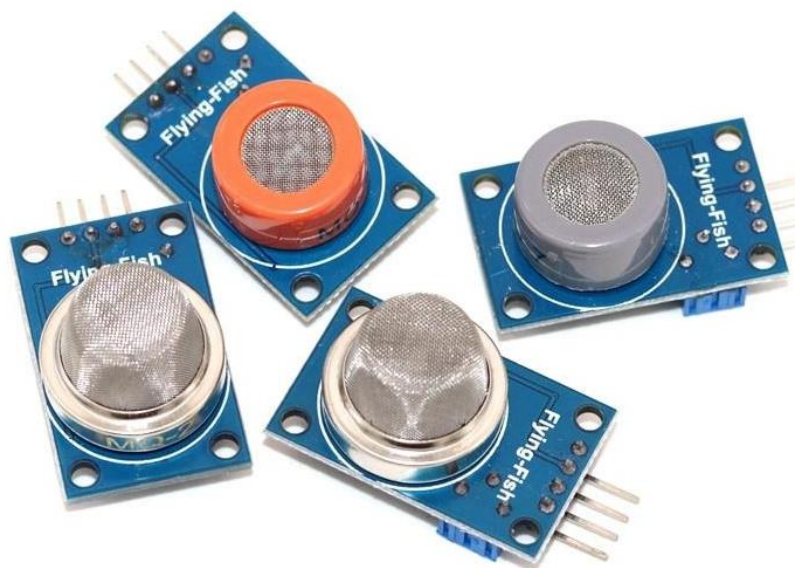
Рисунок 1.9. Модулі виявлення диму, метану, зрідженого газу: MQ-2, MQ-7, MQ-9, MQ-135 платформи Arduino
