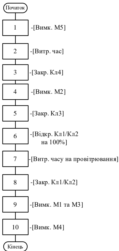
Рис. 4.5 – Блок-схема алгоритму зупинки процесу випічки хліба
