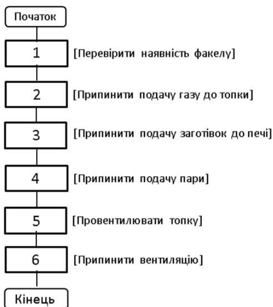
Рис. 4.6 – Блок-схема регламенту аварійної зупинки процесу випічки хліба
