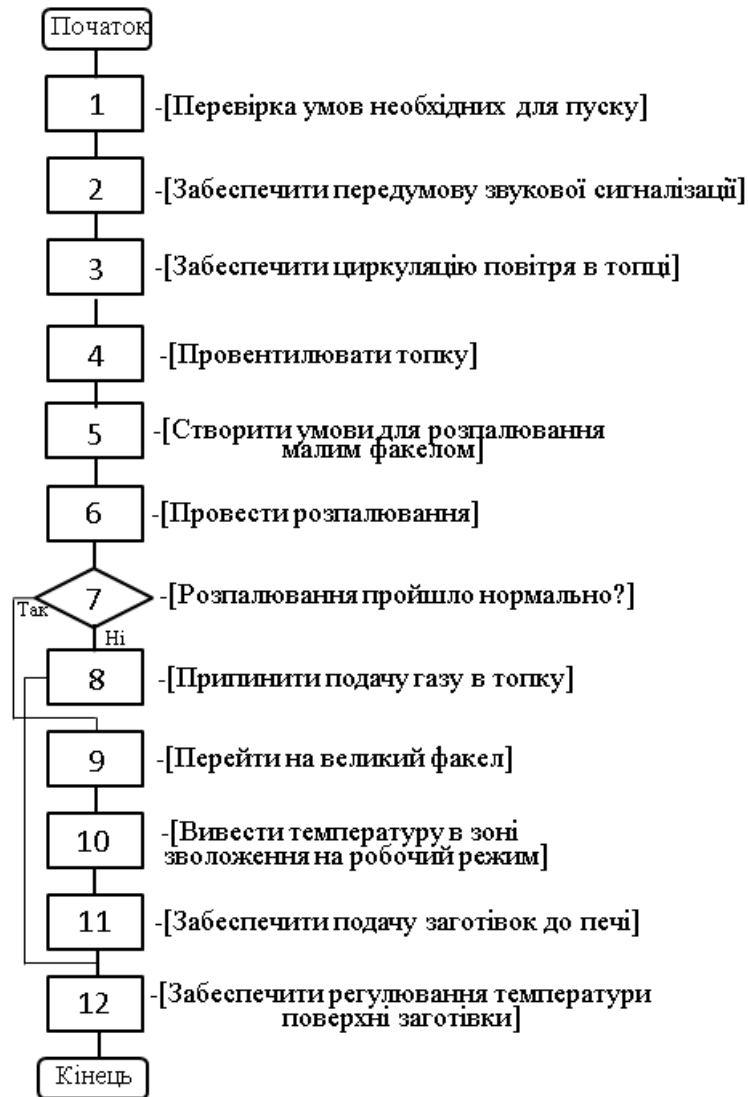
Рис. 4.2 – Блок-схема регламенту функціонування процесу випічки хліба
