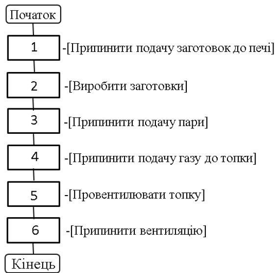
Рис. 4.3 – Блок-схема регламенту функціонування за зупинкою випічки хліба
