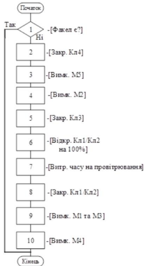
Рис. 4.7 – Блок-схема алгоритму аварійної зупинки процесу випічки хліба
