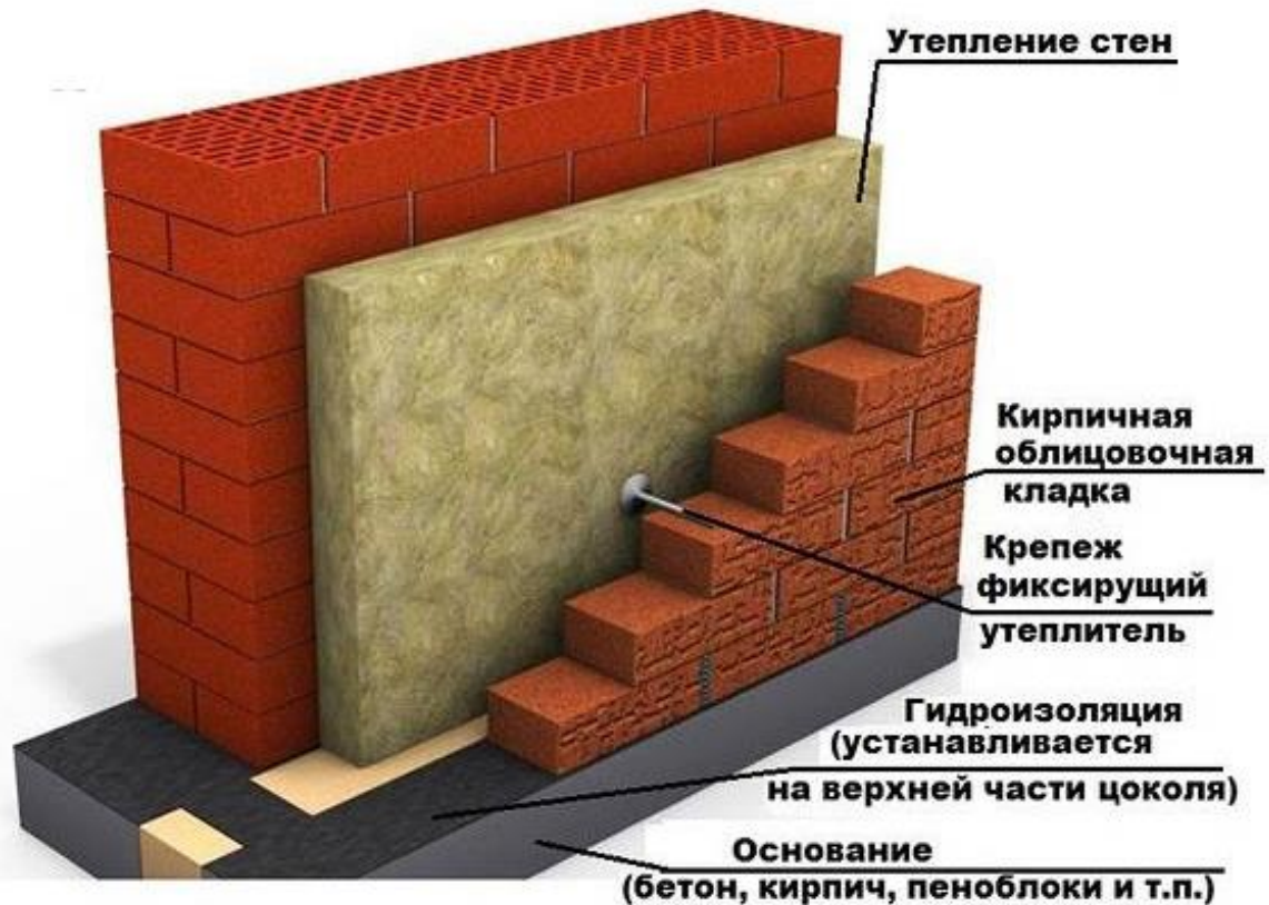
Рис.2.3 Рекомендована конструкція утеплення стін депо.
