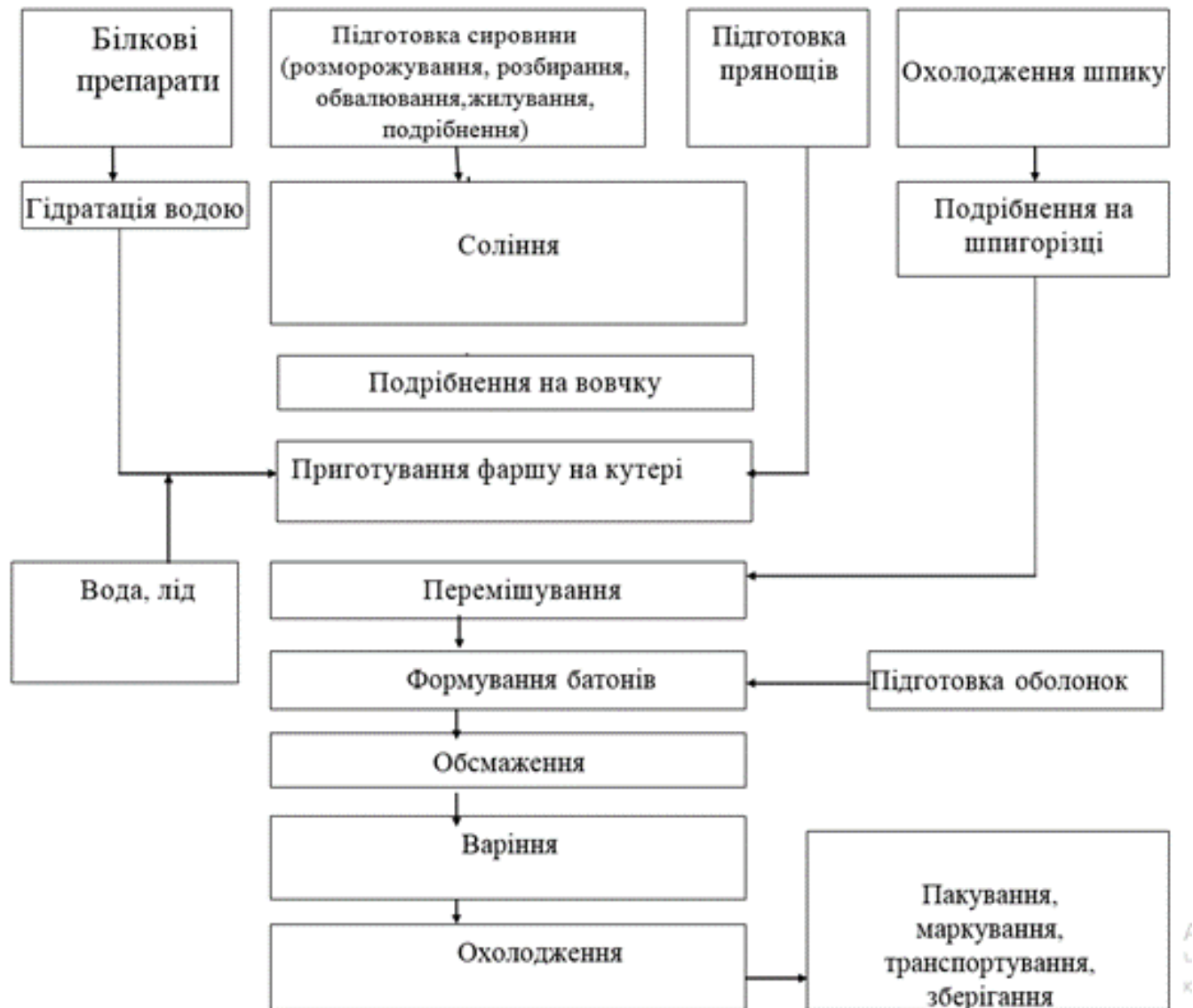
Рисунок 4.1 – Принципова технологічна схема варених ковбас
