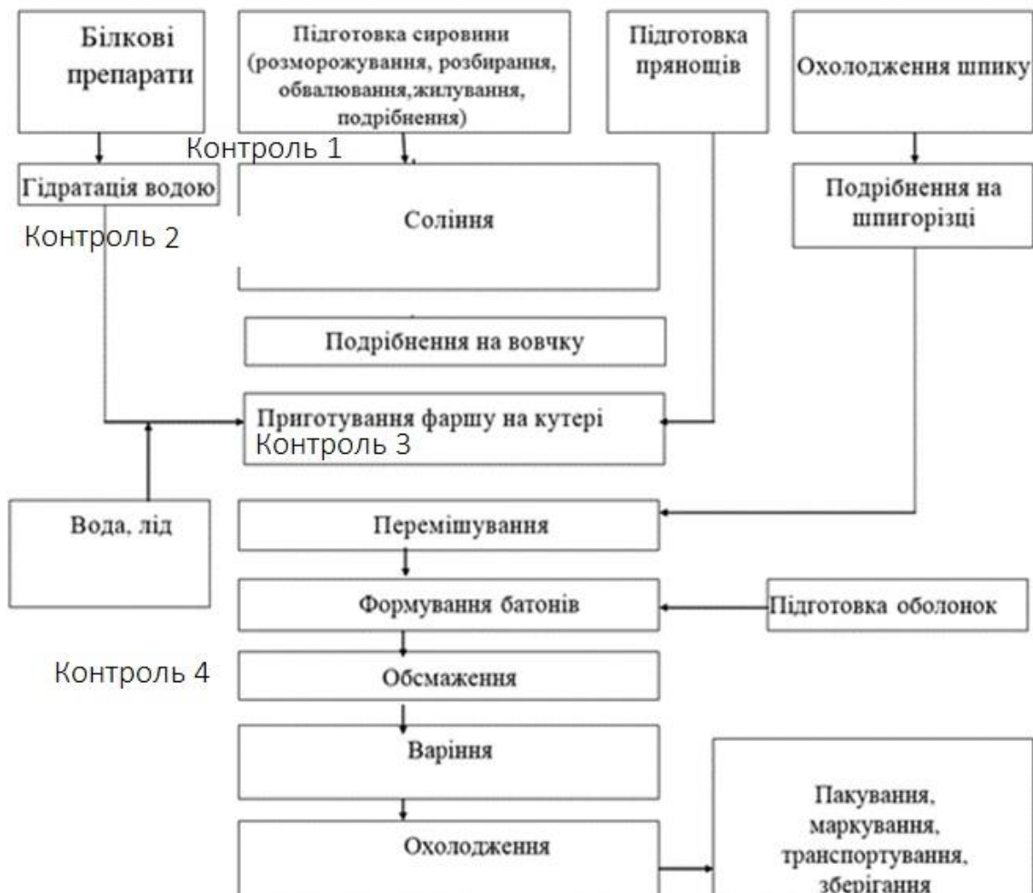
Рисунок 4.2 – Удосконалена технологічна схема варених ковбас з точками сенсорного контролю технологічних показників
