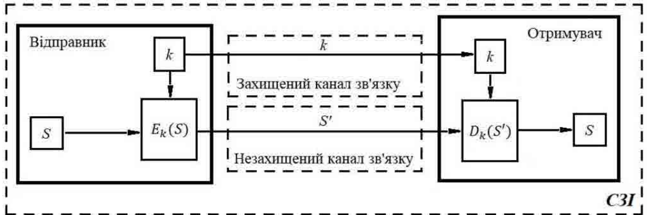
Рисунок 1.20. Структурна схема захищення даних із застосуванням криптографічного методу 2-fish
