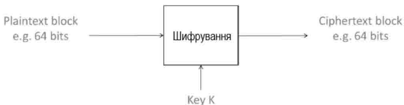
Рисунок 1.4. Принципи блочного кодування
