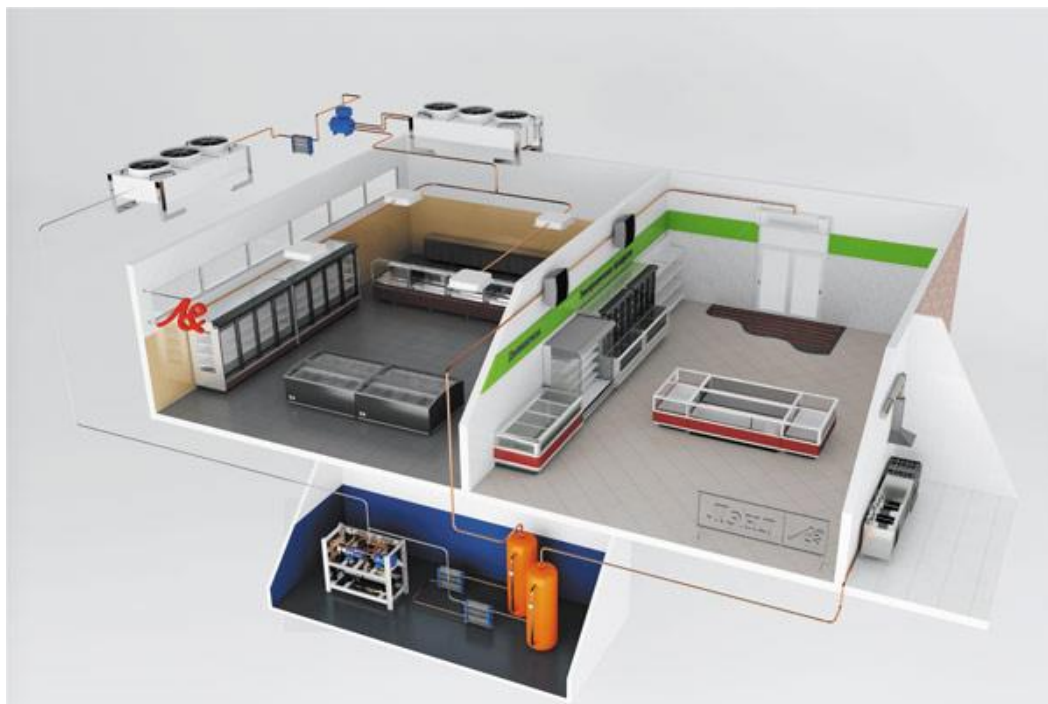
Рис 1.25. Транскритична схема на діоксиді вуглецю для Metro Cash & Carry
