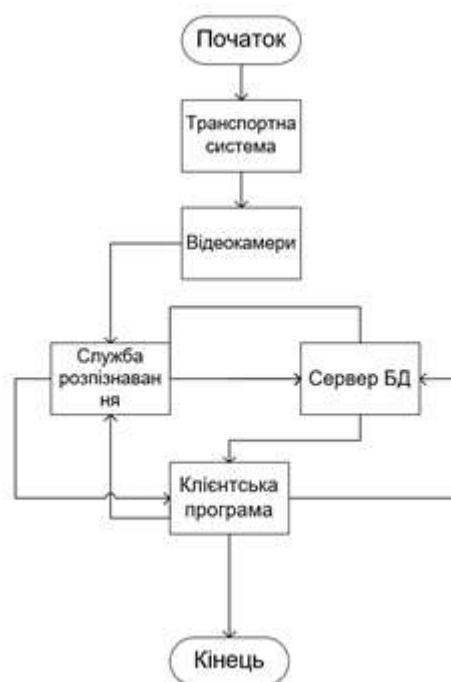
Рисунок 2.2 – Узагальнена система обробки зображення з відеокамер.
