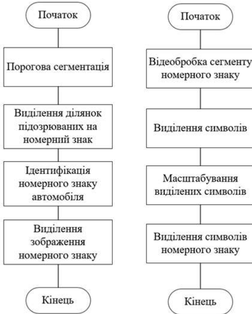
Рисунок 2.4 – Основні етапи процесу виділення зображення номерного знаку автомобіля
