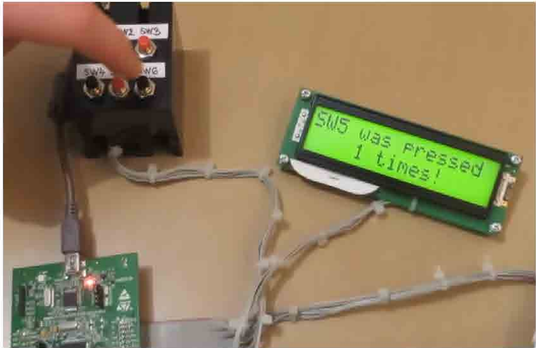
Рисунок 1.23. Демонстрація використання дисплею й управління сигналами
