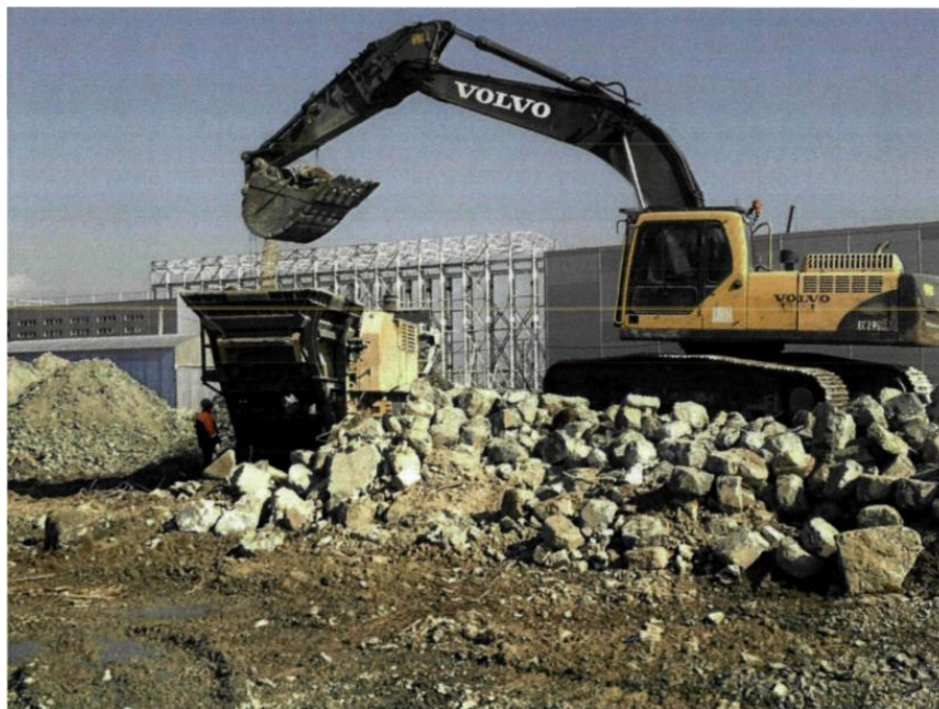
Рис. 2.4 – Загальний вигляд дробарки для подрібнення будівельних відходів
