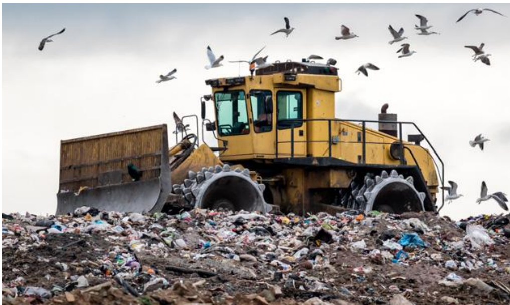
Рис. 2.2 – Штовхання відходів бульдозером
