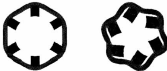
Рис.2. 14. Деформація статора при резонансі на першій резонансній частоті.
