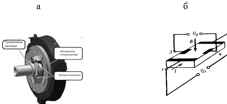
Рисунок 2.2 – Датчик положення ротора: а-конструкція; б- датчик Холла.
