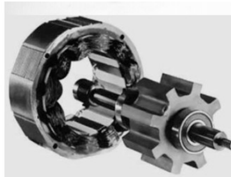
Рисунок-2.4-Конструктивне виконання статора і ротора ВІД
