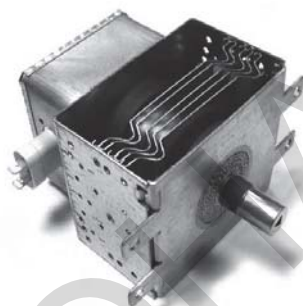
Рисунок 1– Магнетрон з ребрами для повітряного охолодження анодного блоку
