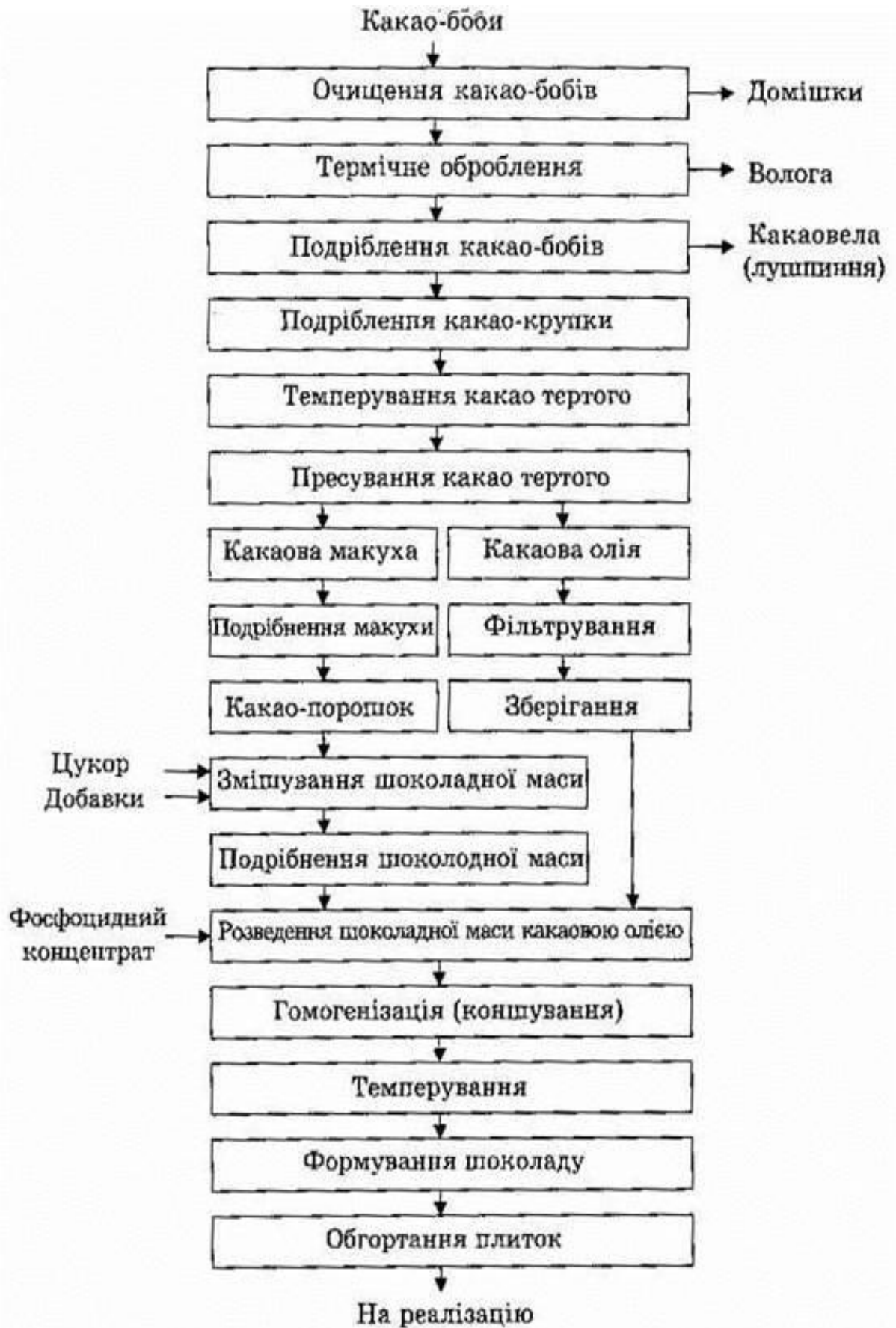
Рис. 1.1. - Технологічну схему виробництва шоколаду
