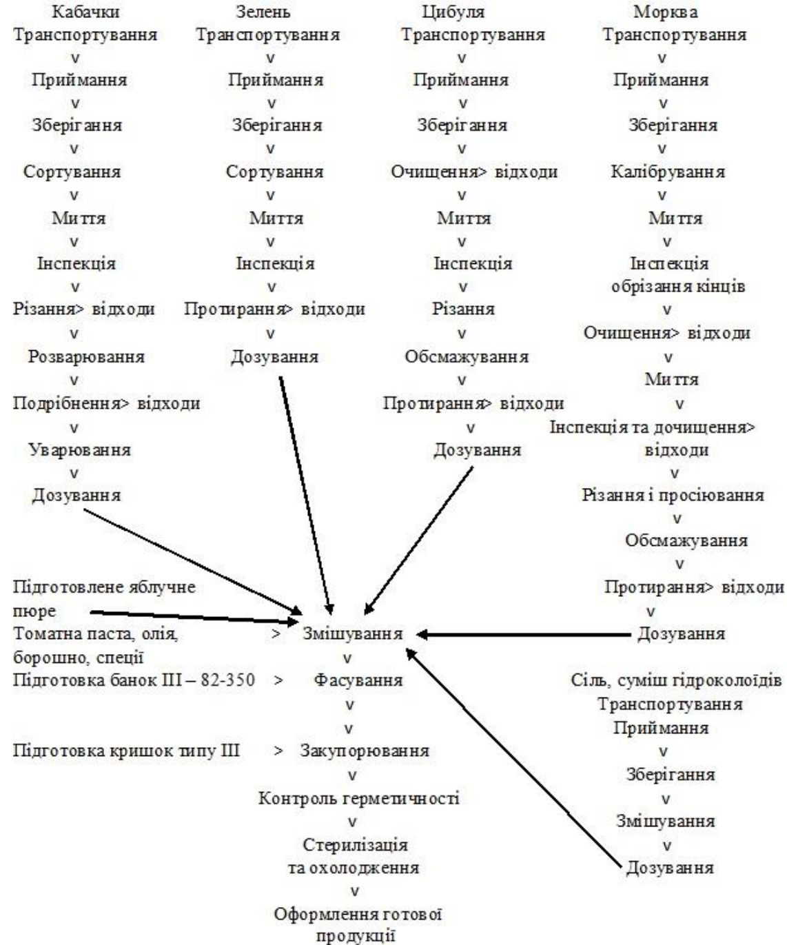
Удосконалена технологічна схема виробництва консервів «Ікра із кабачків»
