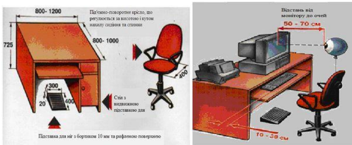
Рисунок 3.1. Конструкція оптимального робочого стола
