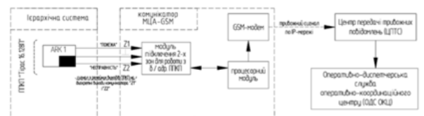
Структурна схема системи центрального пожежного спостереження
