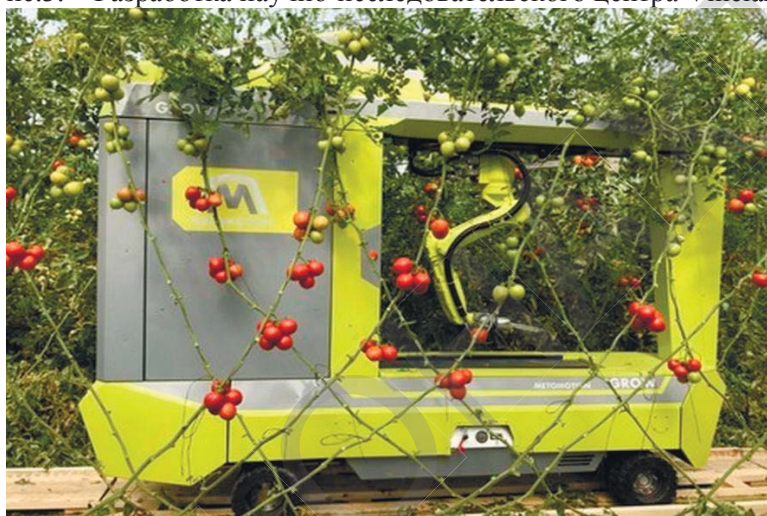
Рис.4. – Роботизированная система по уборке томатов “GROW”
