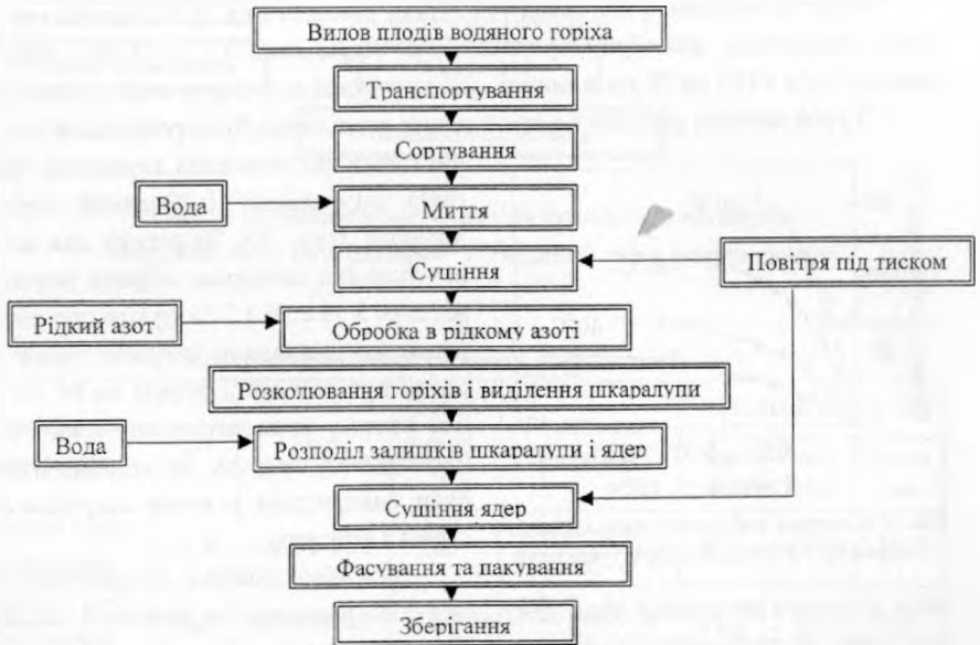
Рис. 8 Функціональна схема отримання ядер водяного горіха
