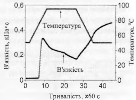
Рис. 5 Аміліграма крохмалю водяного горіха; отримана методом швидкісної віскозиметрії
