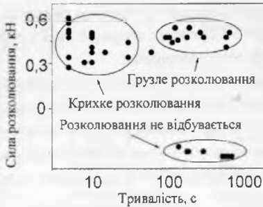
Рис. 7 Залежність сили розколювання від часу після охолодження в рідкому азоті
