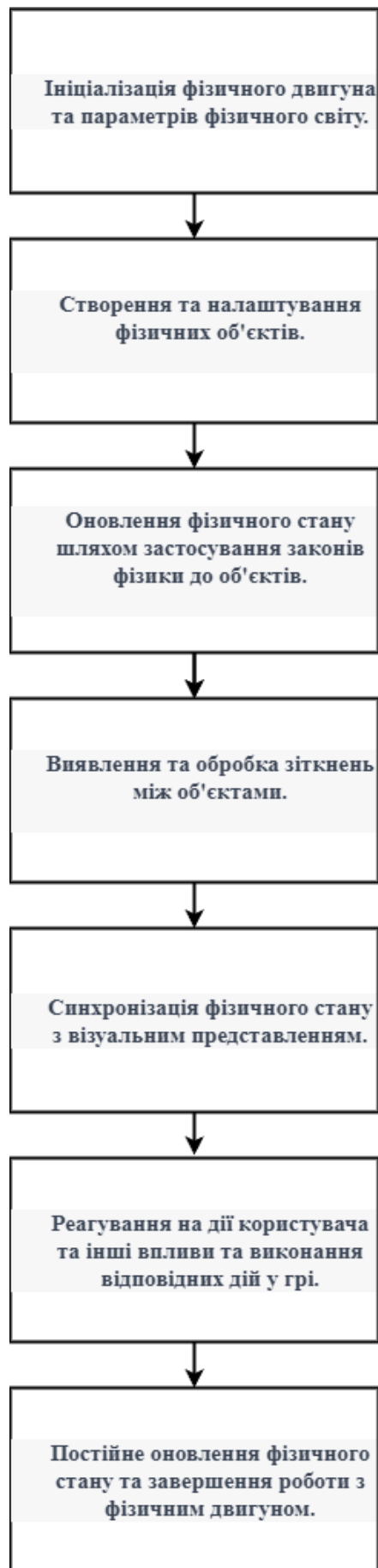
Рисунок 1.15. Функціональна схема роботи з фізичним двигуном
