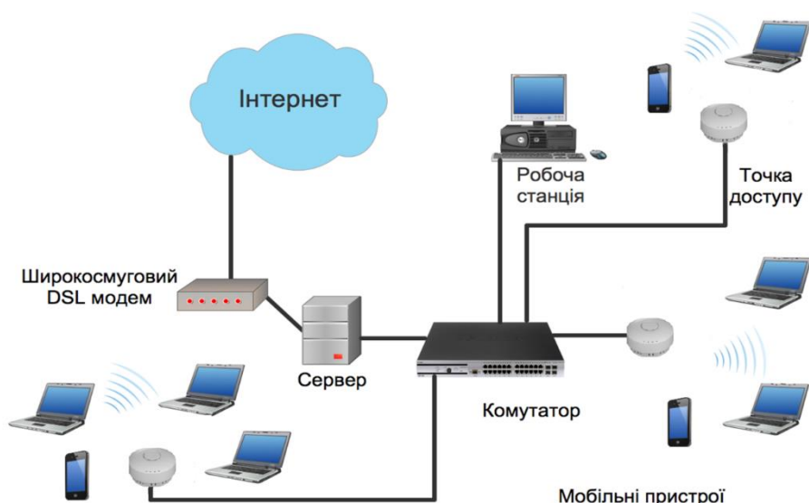
Рисунок 1.7 – Функціональна схема бездротової мережі стандарту IEEE 802.11ac для підприємства громадського харчування з вільним переміщенням клієнтів.
