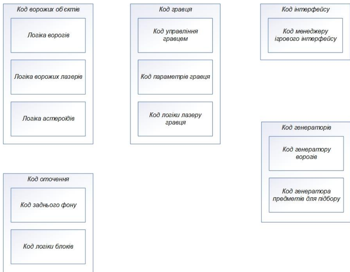
Рисунок 1.11. Схема основних модулів гри та коду, що належить до них
