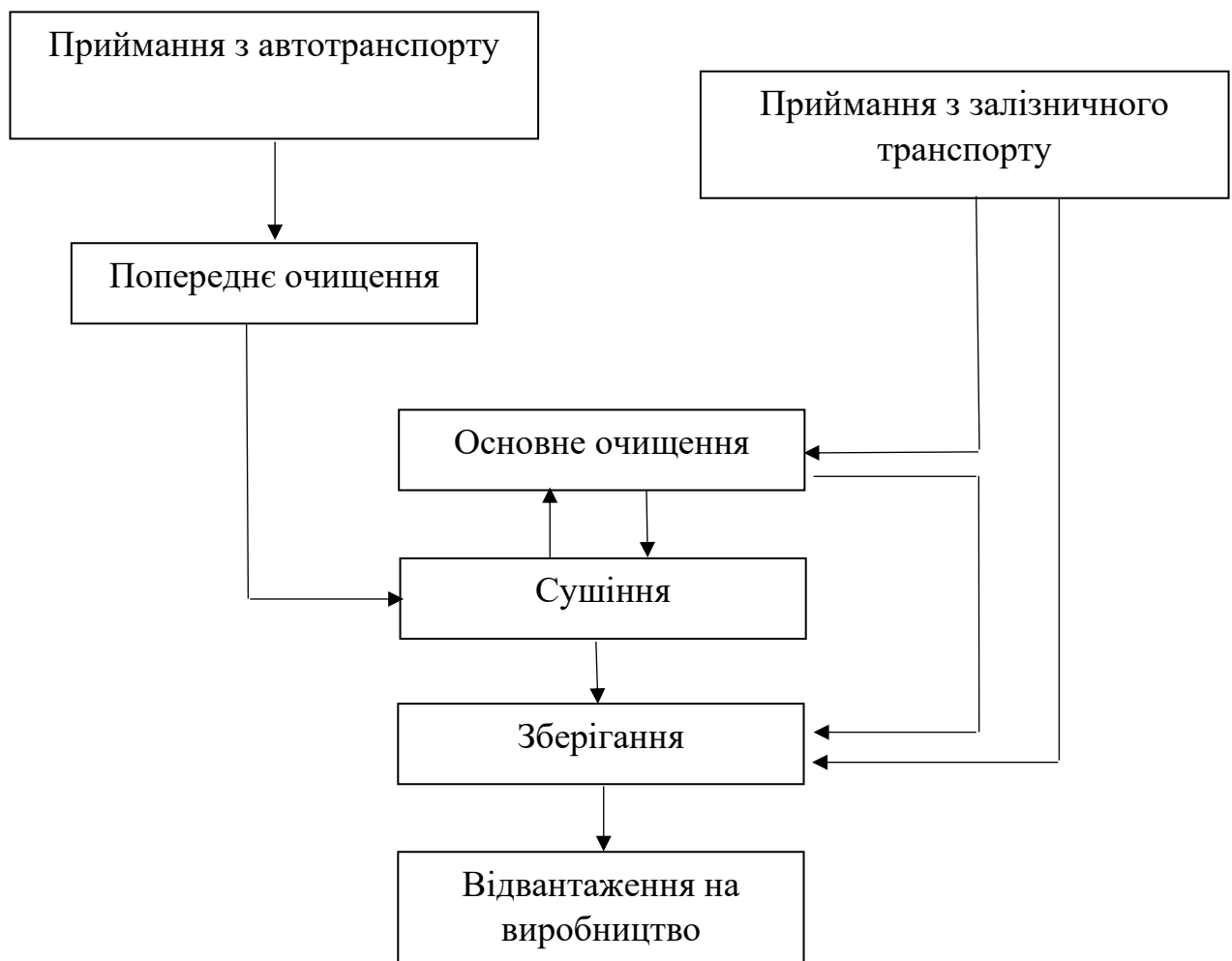
Рисунок 3.1 – Структурна схема роботи елеватора.
