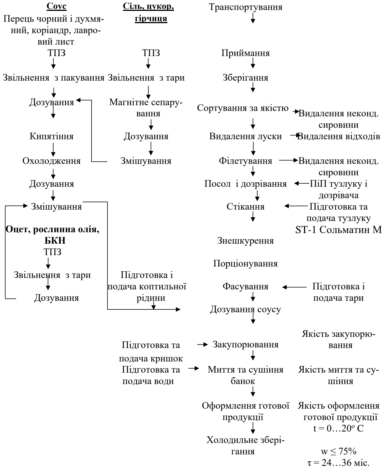
Рис. 3.4 - Технологічна схема виробництва пресервів «Філе-шматочки з товстолобика підкопченого в олії зі спеціями»
