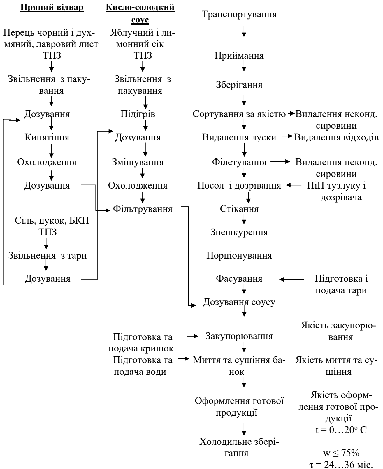
Рис. 3.3 - Технологічна схема виробництва пресеєрвів «Філе-шматочки з товстолюбика в кисло-солодкому соусі»
