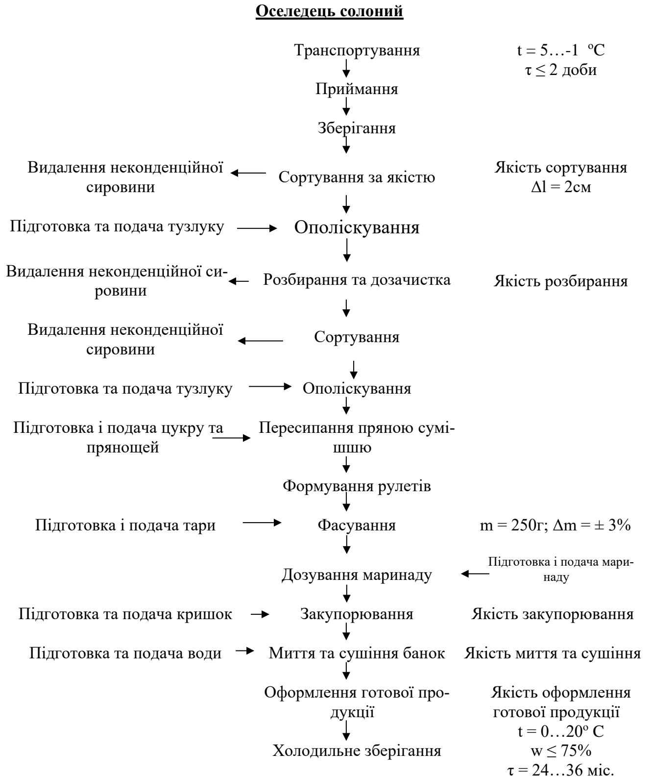
Рис. 3.1 - Технологічна схема виробництва пресервів «Рулетти з оселедцю англантичного в маринаді»
