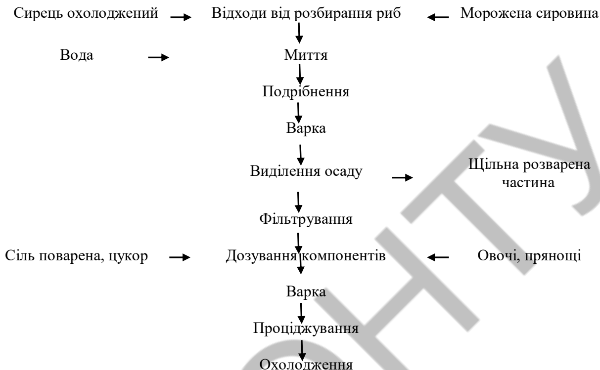
Рис. 2 – Технологічна схема виробництва гелеподібних заливок
