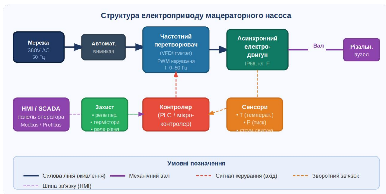
Рис. 1.3 - Структура модернізованого електроприводу мацераторного насоса.
