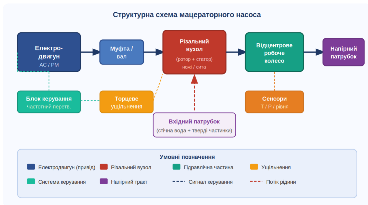
Рис. 1.1 – Структурна схема мацераторного насоса.
