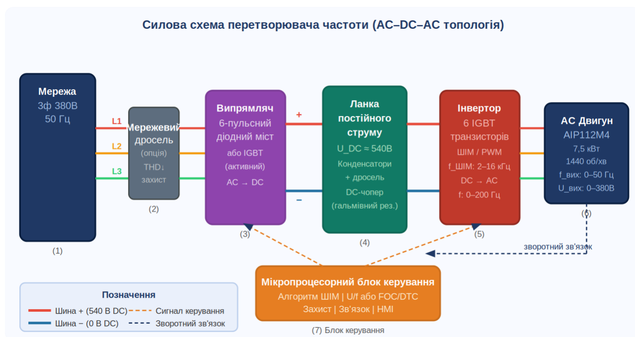
Рис. 2.1 - Силовая схема перетворювача частоти.
