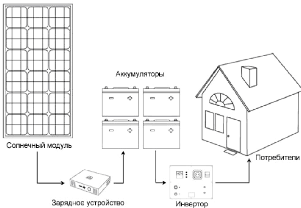
1.11 Класична схема використання сонячних батарей в приватному будинку
