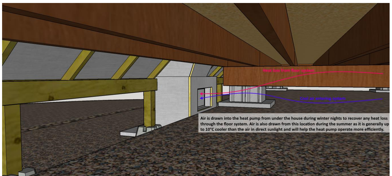
Рис 8.4. Схема руху повітря під будинком.
