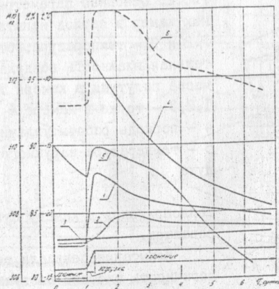
Рис. 4. Влияние загрузки на параметры камеры № 36: 1, 2, 3 — температура воздуха, поверхности и в толще хранимого мяса; 4 — температура в толще загружаемого мяса; 5 — масса пластины мяса; 6 — относительная влажность воздуха камеры
