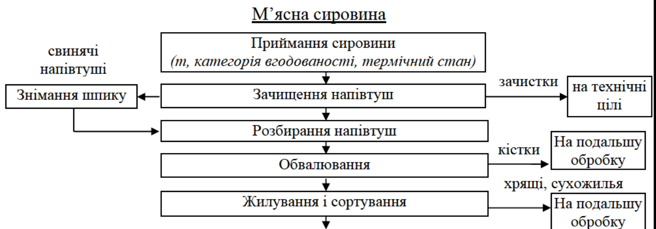
Рис. 4.1.1.– Технологічна схема виробництва посічених напівфабрикатів котлет «Шкільні особливі»
