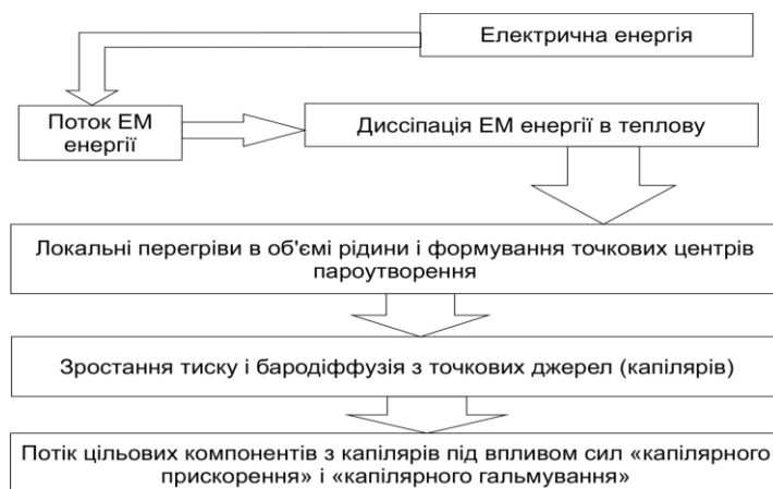
Рис. 5. Електротеплофізична модель пов'язаних процесів масопереносу.
