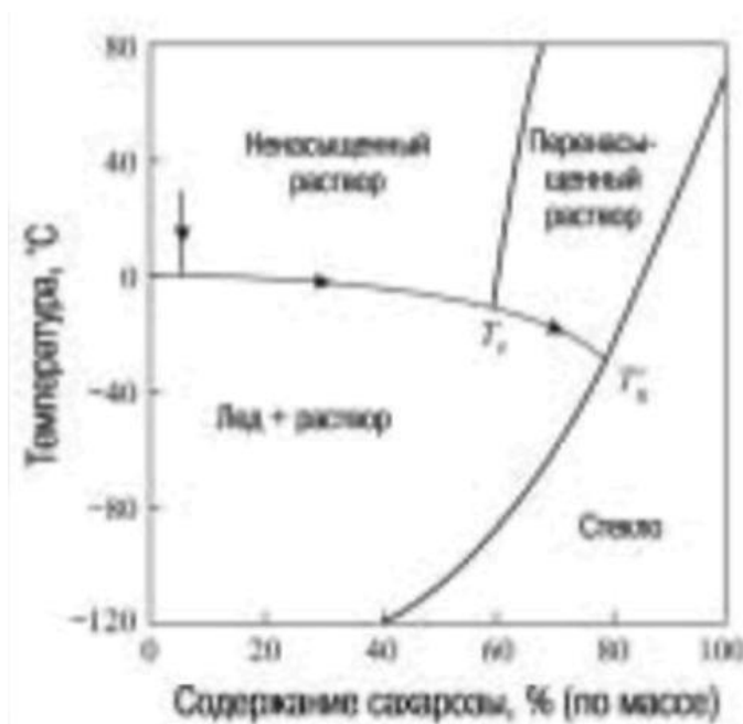
Рис. 1.6 – Діаграма тверда речовина – рідина для системи сахароза – вода
