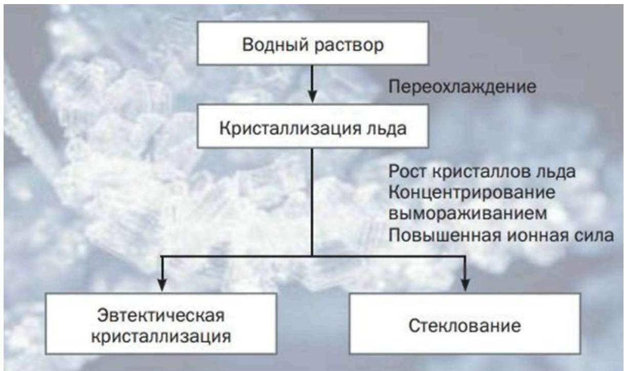
Рис. 1.3 – Різна поведінка водних розчинів при заморожуванні
