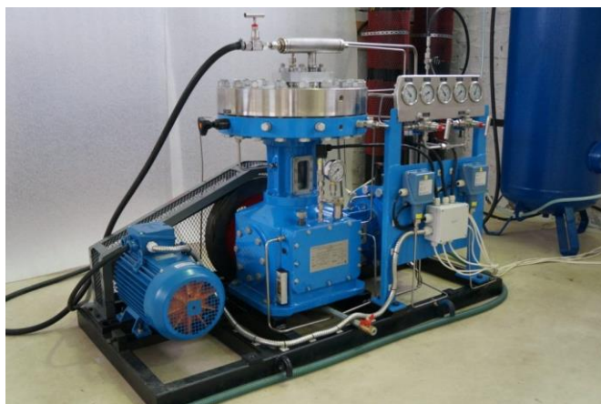
Рис.22. Двоступеневий мембранний компресор Ковинт КСВД-М [22]
