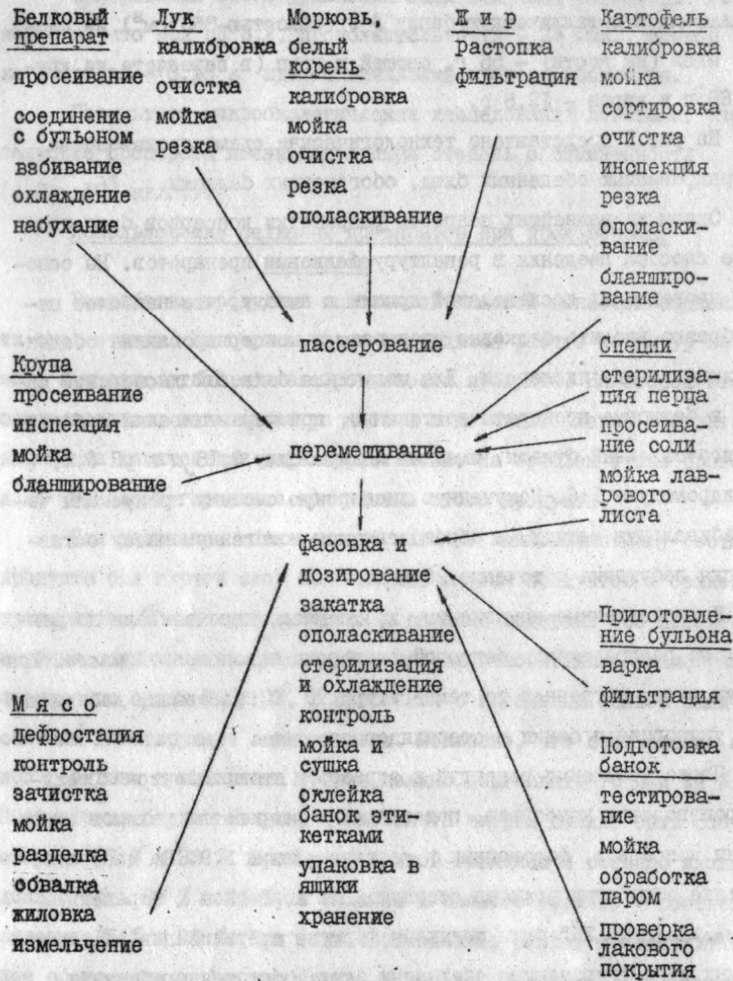
Рис. 1. Технологическая схема производства обеденных консервов, обогащенных белками
