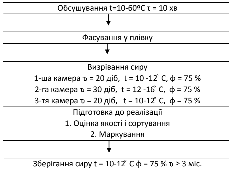
Рис. 1.1 Блок-схема виробництва сиру Гауда
