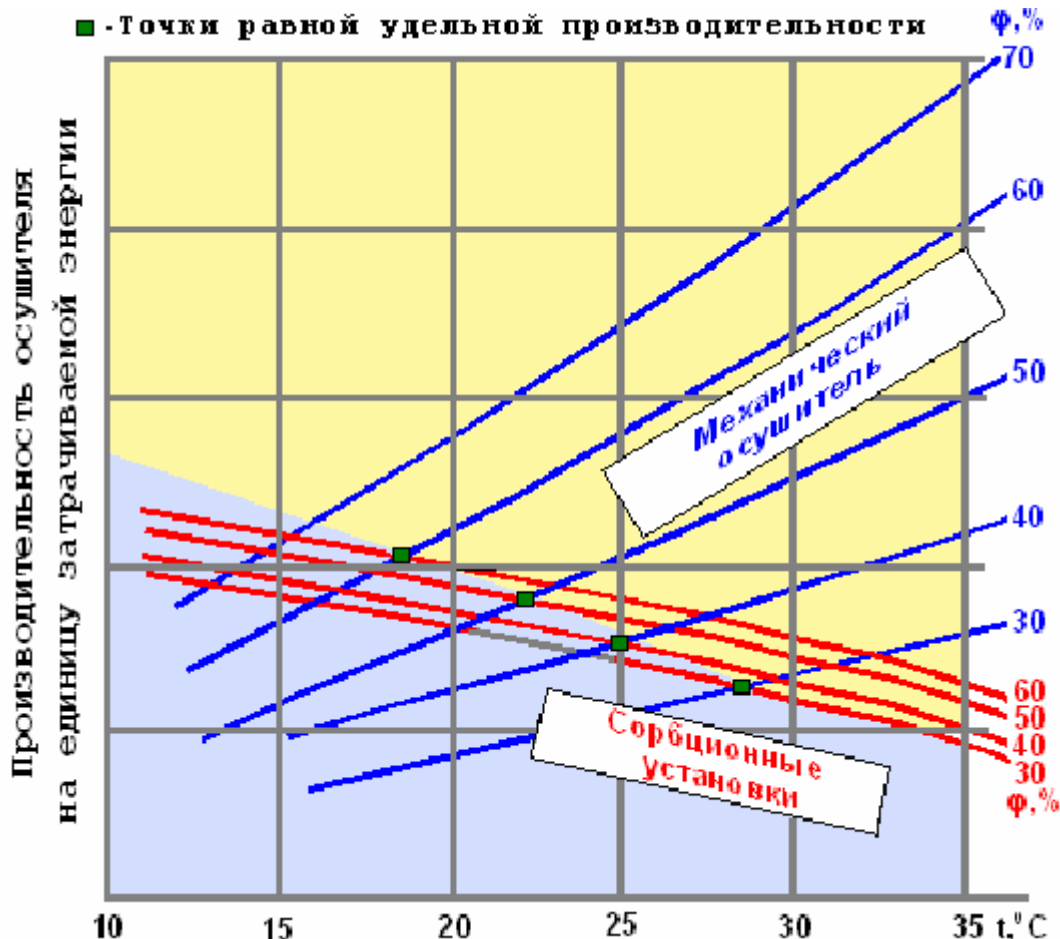
Рис.14 Залежність робочих характеристик осушувальних установок від температури при різних значеннях відносній вологості повітря.
