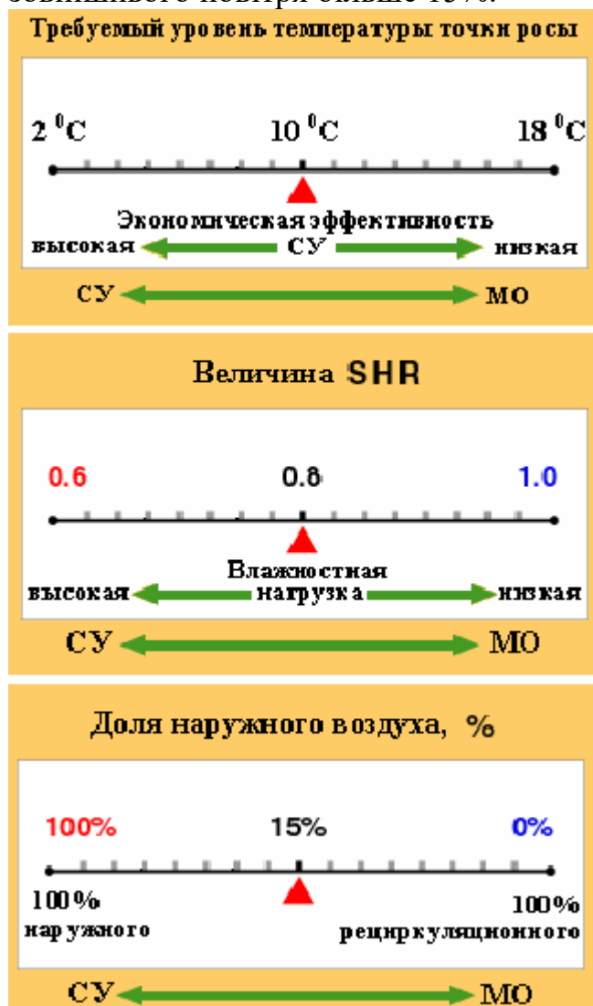
Рис 15 До вибору способу осушення: СУ - сорбційні установки; МО - механічний осушувач
