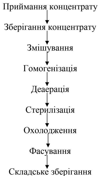
Рисунок 2.1 – Технологічна схема виробництва томатного соку відновленого
