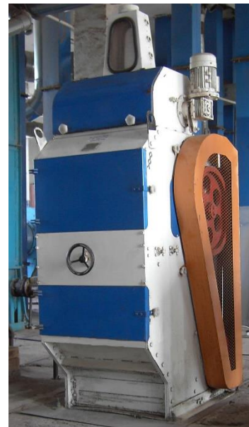
Рис. 1.4. Схема настановного механізму деки (а) та загальний вигляд (б) вальцедекового верстата моделі СGR-600М.
