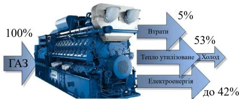
Рисунок 2. Принципова схема тригенераційної установки
