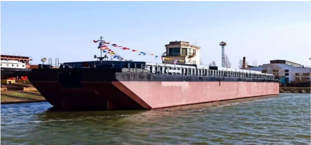
Рис. 3.4. Загальний вигляд баржі Кілійський суднобудівельно-судноремонтний завод SLG-021 вантажопідйомністю 2200 тонн.
