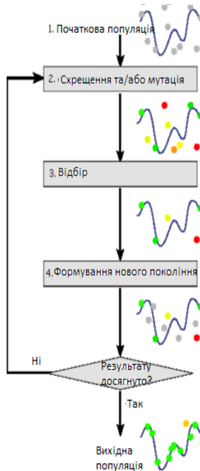
Рисунок 1. 5. Схема роботи генетичного алгоритму
