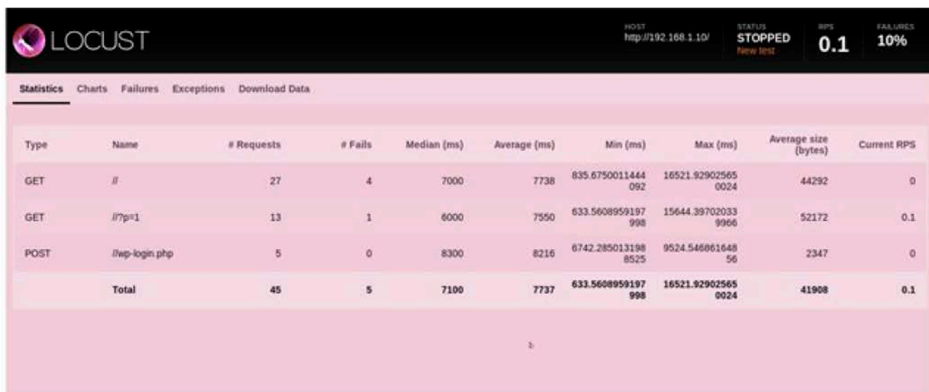
Рисунок 1.36. Результати тестування продуктивності балансувальника навантаження HAProxy на динамічному змісті за алгоритмом Weighted Round Robin для конфігурації “комп’ютер 1 працює, комп’ютер 2 вимкнений”
