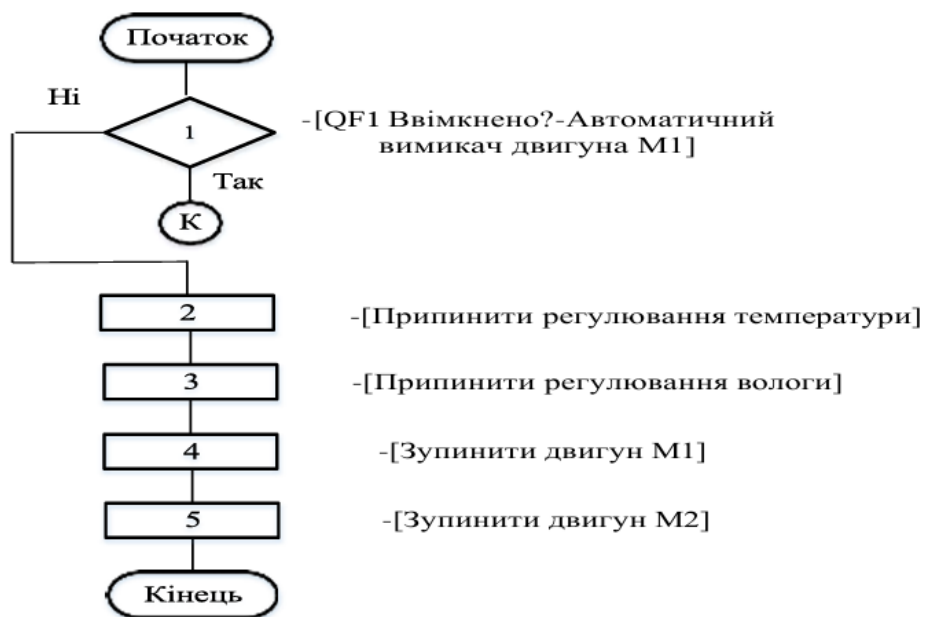
Рис. 4.6 – Блок-схема регламента на аварійну зупинку
