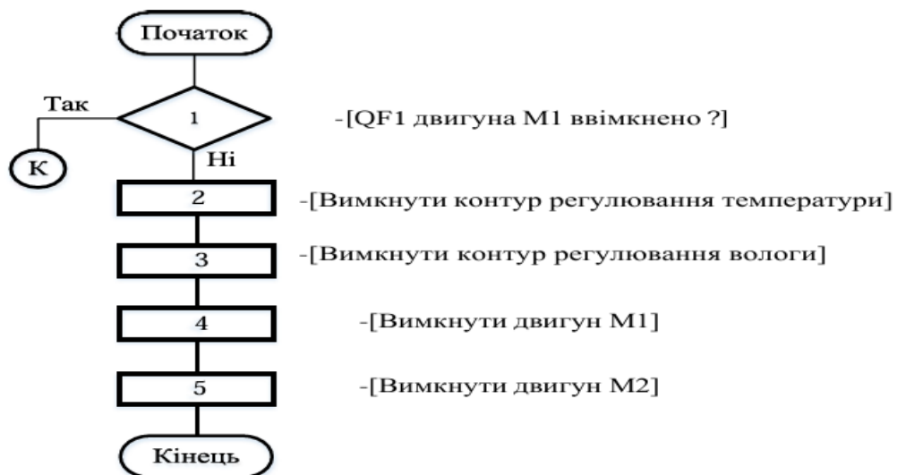
Рис.4.10. Блок - схема автоматичного управління аварійною зупинкою
