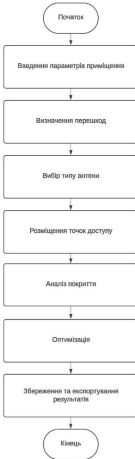
Рисунок 1.7. Блок-схема алгоритму основних етапів використання програми D-Link Wi-Fi Planner
