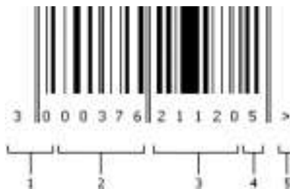
Рис 3.2.4 – Лінійний штрих-код системи EAN-13
