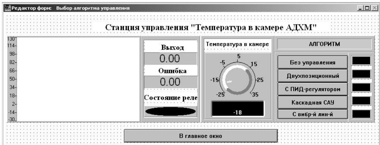
Рис. 5 – Фрагмент вікна станції управління
