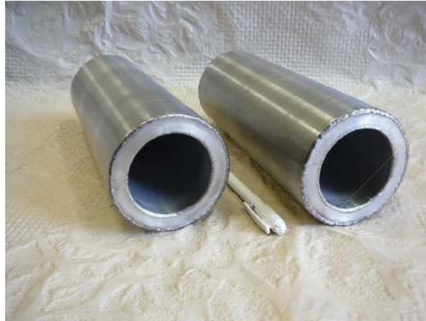
Рис. 1 – Робочі дільниці (загальний вигляд) прецизійних термостатів, розроблених та створених в ІПМ ім. І.М. Францевича на основі коаксіальних теплових труб з волокнистими капілярними структурами ( діапазон температур: мінус 70...+ 70 °С )
