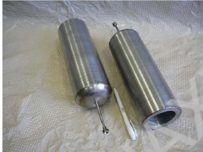
Рис. 3 – Робочі дільниці прецизійних «нуль»-термостатів, розроблених в ППМ ім.І.М. Францевича, у стані поставки
