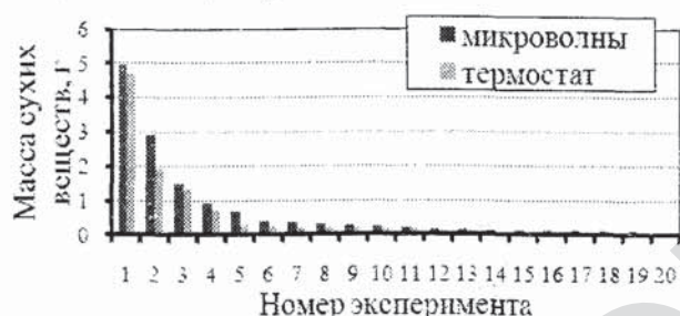
Рис. 1 Определение содержания сухих веществ в кофе
