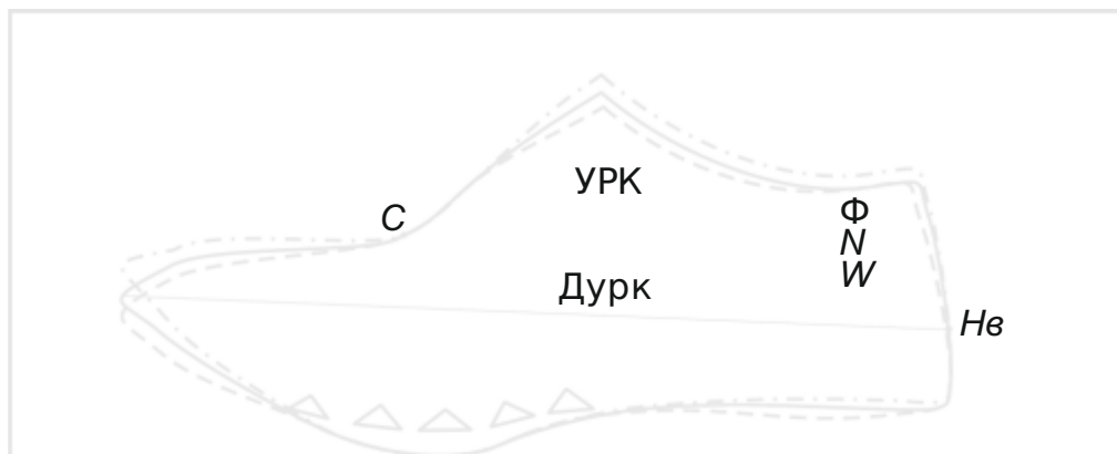
Рис.2.1.1 Одержання умовної розгортки бічної поверхні колодки
