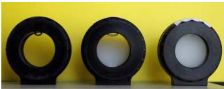
Рис.3.3 Фотографія холодоносія (ХН) без добавок наночастинок (зліва), холодоносія з домішками наночастинок Al_2O_3 з концентрацією 0,53мас. % (наноХН) зберігаються в статичних умовах протягом 12 діб (посередині) і нанохолодоносія з домішками наночастинок Al_2O_3 з концентрацією 0,53 мас.% (наноХН) піддавався механічному перемішуванню перед проведенням досліджень (праворуч) в оптичних осередках з довжиною оптичного шляху 4,05 мм
