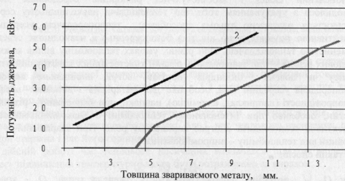
Рис. 3. Значення необхідної потужності теплового джерела, з урахуванням кількості тепла, що витрачається на розплавлення металу.
