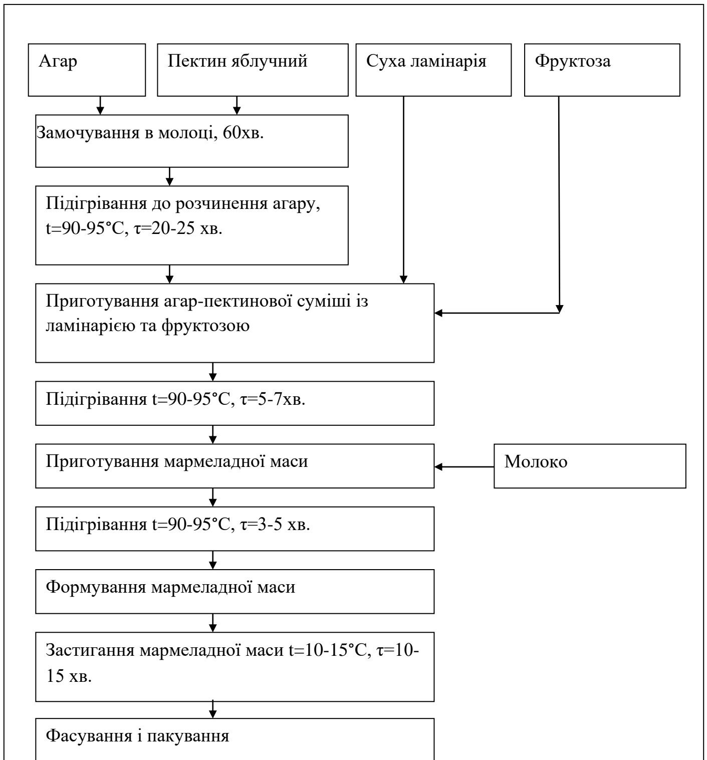
Рис. 2.6. Загальна функціональна схема виробництва мармеладу з ламінарією
